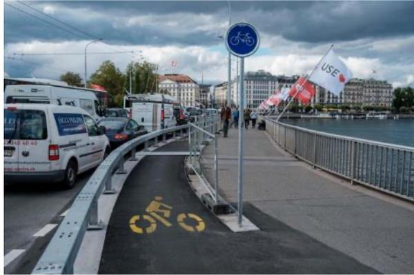
Figure 29. VOIE CYCLABLE ET TROTTOIR SÉPARÉS DU TRAFIC SUR LE PONT DU MONT-BLANC, GENÈVE
