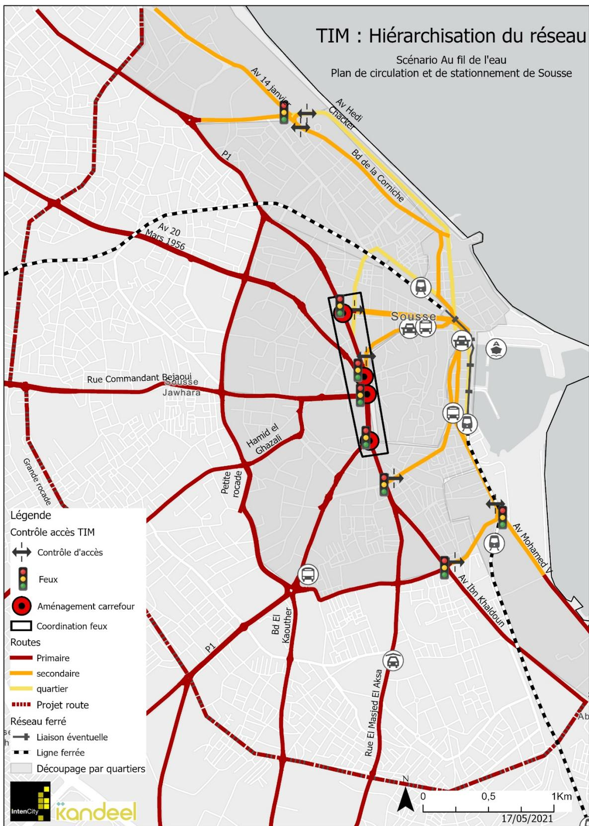
Figure 4 : Hiérarchisation du réseau pour les transports individuels motorisés, Scénario Au fil de l'eau. Source : Kandeel et IntenCity, 2021
