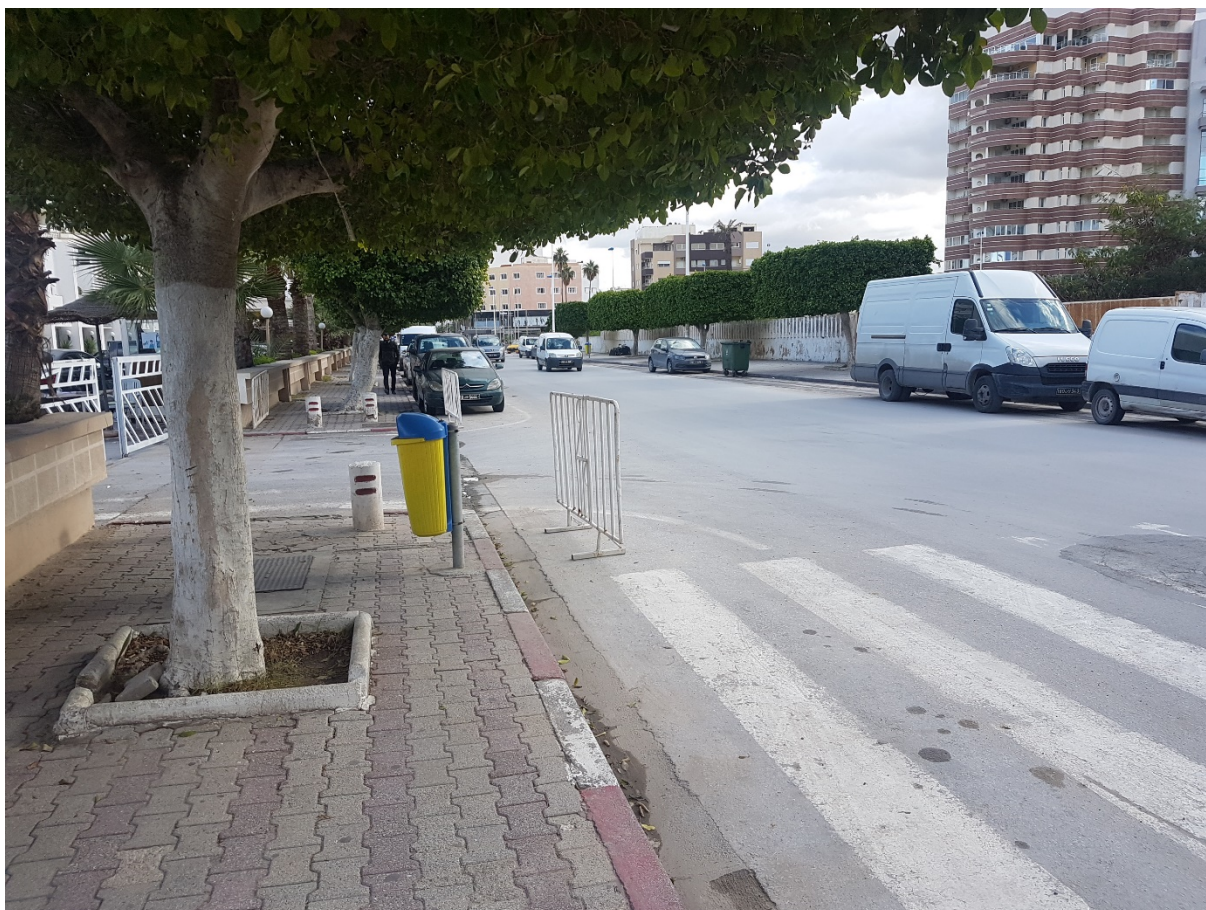
Figure 64 : Trottoir le long du Bvd du 14 janvier, en direction de la Corniche. Les trottoirs sont très fréquemment coupés par les accès aux hôtels et les potelets mis en place à cet effet. Photo : Kandeel, 2020
